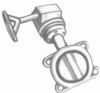
Consisten en una carcasa, generalmente de hierro fundido, con el mismo diámetro de la tubería y dentro de la cual va instalada una lenteja circular que gira 90° alrededor de su eje. Estas válvulas se ubican dentro de cajas de concreto.
