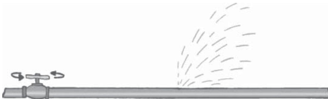
2. No permita que las válvulas se cierren forzosamente, evite que se peguen.
