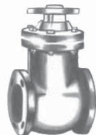
Estas válvulas son de construcción sencilla, de apertura y cierre lentos, lo cual evita golpes de ariete. Pueden ser reparadas en el sitio sin necesidad de ser retiradas. Sirven para vaciar completamente una estructura, bien sea para mantenimiento o reparación. Son muy comunes a la salida de las plantas de tratamiento y en la red de distribución. Permiten regular el caudal según la necesidad.
