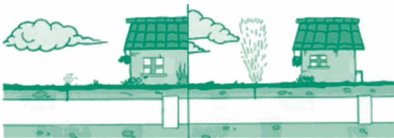
Dependiendo de la presión que el agua tenga dentro de la tubería, el líquido podrá subir por encima del nivel de la tubería, sin necesidad de ayuda adicional. Por eso la presión se expresa comúnmente en metros de columna de agua.
