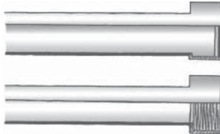
El diámetro y diseño de los accesorios se adaptan a las condiciones de las tuberías a las cuales se conectan. Para el caso de las tuberías de PVC, los accesorios vienen para presión y unión mecánica.
